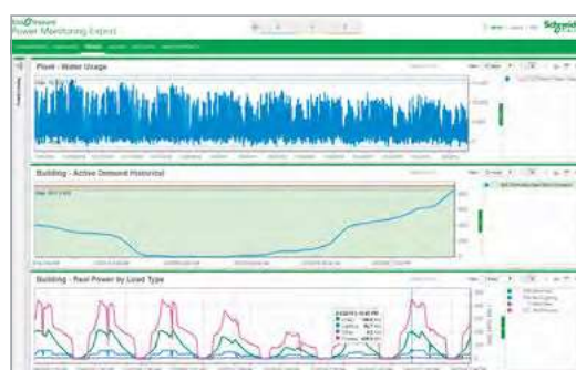
Suivi et alerte en temps réel des paramètres énergétiques ou de qualité de l'énergie
