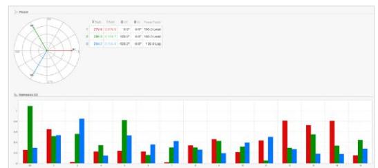
Vue du phaseur et détails des harmoniques
